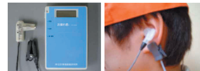
熱中症予防リアルタイム遠隔監視装置 イヤホン型の連続鼓膜温センサー
